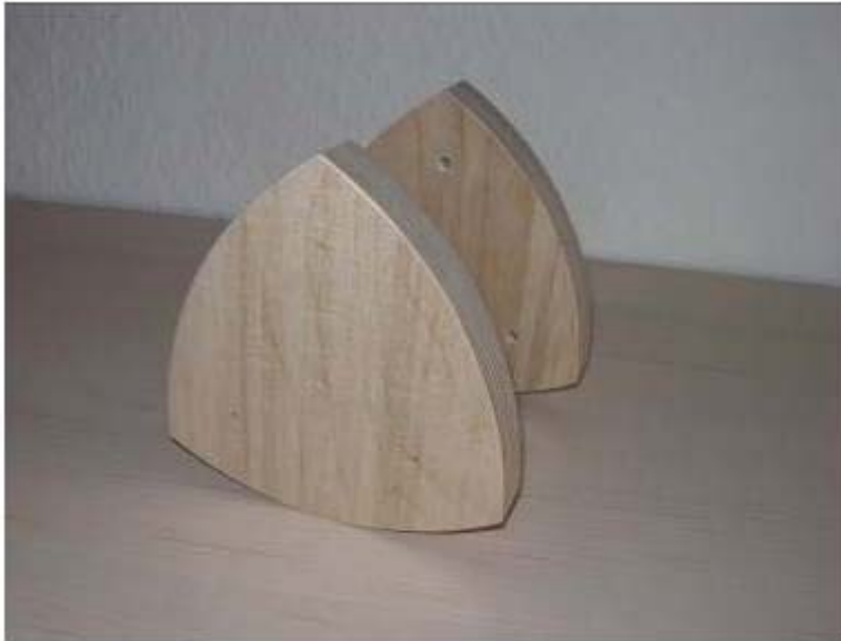
KUVA 3. Rullakko 3, jossa kiekot ovat "pullistuneen kolmion" muotoisia "Pullistunut kolmio" tarkoittaa ns. Reuleaux'n kolmiota, ja on kolmio, jonka sivut ovat pullistuneet (kuva 4).
