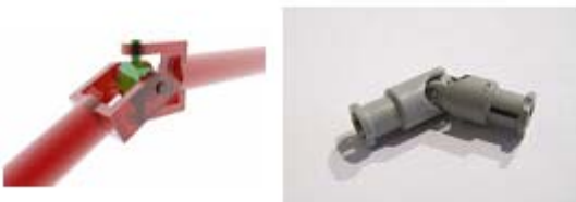
Kuvio 5. Kardani – kardaniakseli, piirros ja Legon pyörivä nivel
